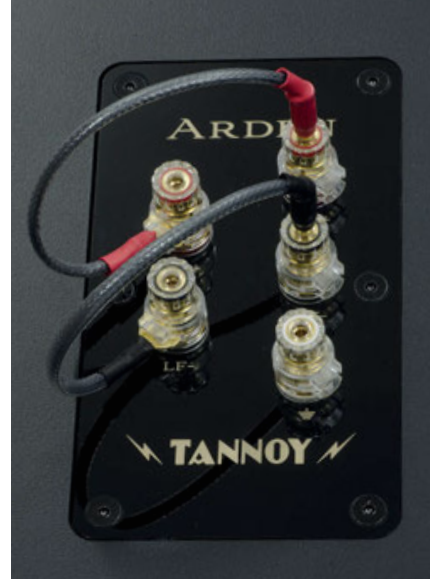
La morsettiera posteriore è dotata di morsetti di buon pregio e di ponticelli di filo di buona sezione. Notare il quinto ponticello che fa capo al cestello del woofer e che deve essere collegato alla terra dell'elettronica di potenza.
