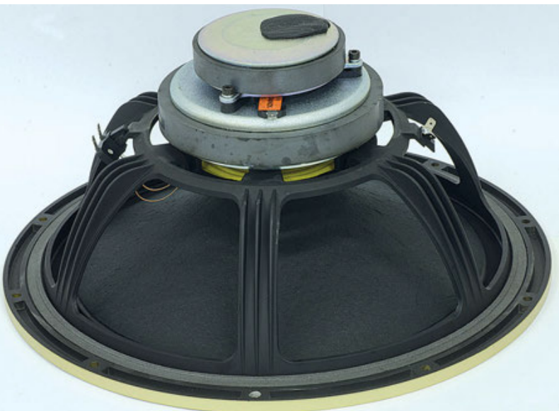
Il driver coassiale della Tannoy è stato modificato nel tempo per allinearne le caratteristiche che deve avere un altoparlante per uso home. Note il ridotto diametro della bobina mobile, il secondo anello magnetico del tweeter che è fissato alle spalle del complesso magnetico del woofer. I cordini molto abbondanti lasciano intuire una notevole escursione meccanica.
