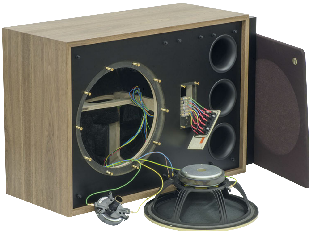
Il diffusore completamente smontato. Possiamo vedere i rinforzi interni, le viti inserite nelle madreviti, il pannello di controllo del tweeter ed il trasduttore coassiale con il tweeter rimosso.
