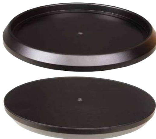
La parte superiore del piatto è realizzata con un disco in vetro molto spesso al quale è stato fissato nella parte inferiore un profilo in alluminio sagomato a V lungo il bordo esterno che conferisce una forma slanciata nonostante lo spessore complessivo sia piuttosto elevato. Non si apprezzano particolari interventi di appesantimento o di controllo delle vibrazioni. La rotazione del piatto è stabile e molto precisa.
