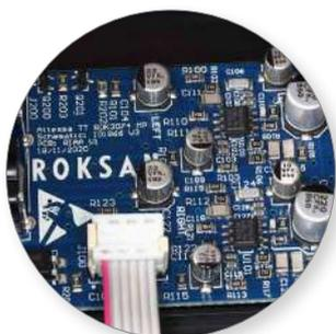
Al di sotto del braccio è presente il circuito di amplificazione phono MM realizzato ad hoc per la serie Attesa, sviluppato con tecnologia SMD e amplificatori operazionali Texas N5532. Lo stadio è escludibile tramite un selettore a fianco delle connessioni RCA per l'utilizzo di un pre phono esterno.
