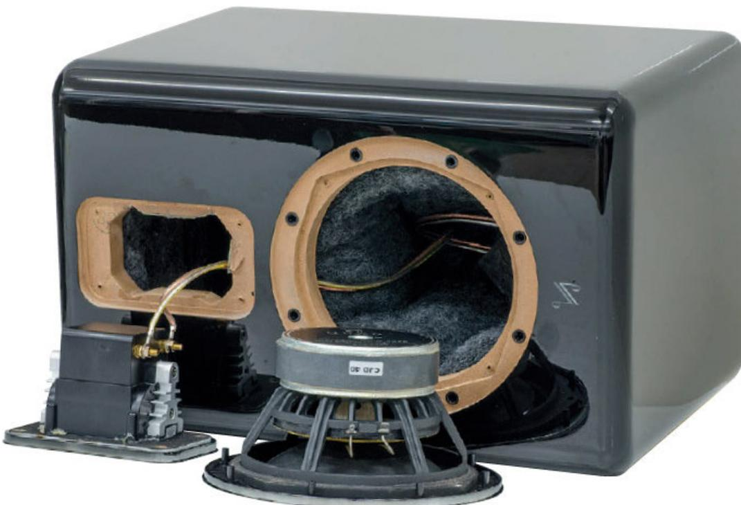
I componenti sono di ottima fattura e ben dimensionati. Le viti sono celate da apposite ghiera a pressione. Il midwoofer ha la struttura portante in lega, dotata di ampi spazi per agevolare il passaggio dell'aria. Sotto lo spider si intravede il supporto della bobina mobile con uno dei fori per lo smaltimento del calore. Imponente la costruzione del tweeter, da notare i due radiatori in alluminio per evitare il riscaldamento della membrana.
