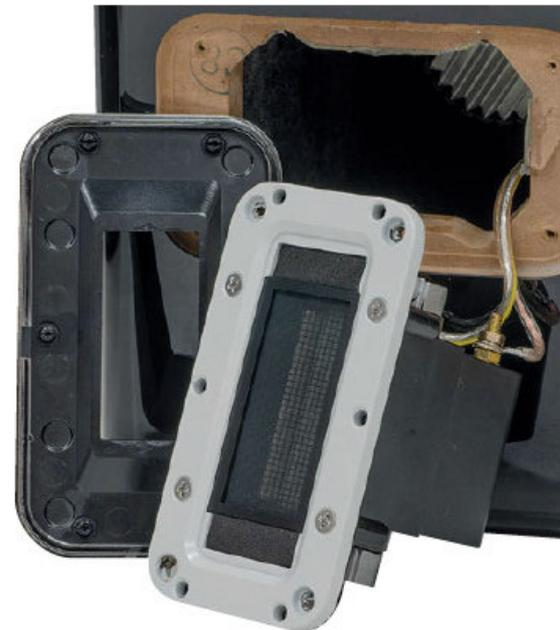
Il tweeter "nudo" che una volta avvitato viene coperto dalla ghiera con la stessa finitura del mobile.
