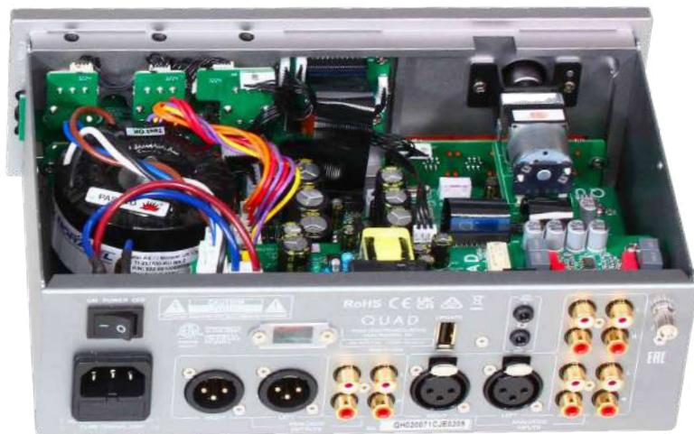
Il circuito di alimentazione impiega un trasformatore toroidale incapsulato con uno schermo elettromagnetico e una batteria di filtraggio ad alta capacità con circuiti di filatura e stabilizzazione SMD installati sul PCB principale di smistamento delle alimentazioni.
