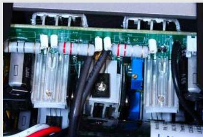
massa con inerzia termica collegati al PC tramite i lunghi reofori. Il trasformatore toroidale è inserito in un guscio di schermatura elettromagnetica e la sezione di rettificazione è collocata in alto con una batteria di condensatori da 60.000  $\mu$ F da 50V complessivi. I segnali in ingresso sono gestiti da un PCB a ridosso delle connessioni in cui si può scegliere il tipo di connessione e la configurazione del finale nella modalità stereo o a ponte.
