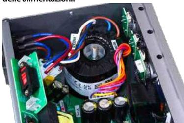
L'anima totalmente analogica ma di nuova impostazione è evidente dal pre phono RIAA realizzato con integrati ma componenti di alta qualità tipo condensatori a film MKT e resistori tradizionali di tipo MELF per l'installazione sui PCB SMD e un potenziometro ALPS motorizzato.
