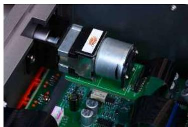
Devices LT1115 a bassissimo rumore impiegati nello stadio phono. L'anima analogica del sistema la si riscontra anche nella regolazione del volume con un ALPS motorizzato e nel controllo dei toni, implementato direttamente sul PCB con componenti ad hoc selezionabili con i commutatori a stato solido. Si apprezzano anche componenti selezionati strategicamente in funzione della posizione del circuito, tanto che alcuni
