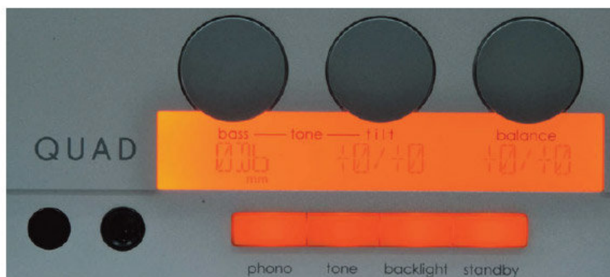
Il frontalino del preamplificatore. Il volume controlla un bel potenziometro ALPS logaritmico e motorizzato da 20 kohm, le manopoline sulla destra regolano i toni ed il bilanciamento a passi discreti di 1 dB, fino a ±3 dB. Una doppia pressione sul selettore dell'ingresso fono determina il cambio di amplificazione e impedenza d'ingresso, da MM a MC e viceversa. Un pulsante controlla l'attivazione del display ma anche la luminosità ed il contrasto, regolabili anche da telecomando.
