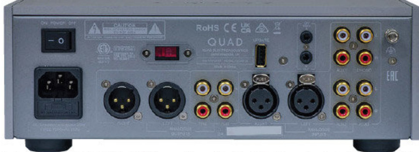
La dotazione in/out del Quad 33 è completa a dispetto delle dimensioni: quattro ingressi linea, uno dei quali bilanciato, uscite verso il finale sia bilanciate che sbilanciate, più un'uscita a livello fisso. Due uscite trigger a 12 volt consentono l'accensione remota di altri apparecchi, ed un ingresso USB A viene utilizzato per i futuri upgrade del firmware.
