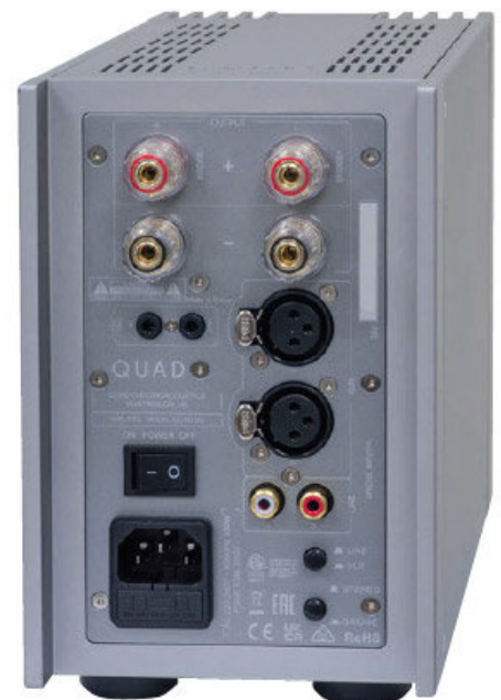
Il pannello posteriore del Quad 303 con i morsetti in stile WBT ed i doppi ingressi bilanciati/sbilanciati, commutabili con uno dei due pulsantini in basso. L'altro serve per scegliere la configurazione, stereo oppure monofonica a ponte. Spicca naturalmente la scritta "Made in China", da quasi trent'anni Quad è stata infatti acquisita dalla International Audio Group con quartier generale e produzione a Shenzhen.
