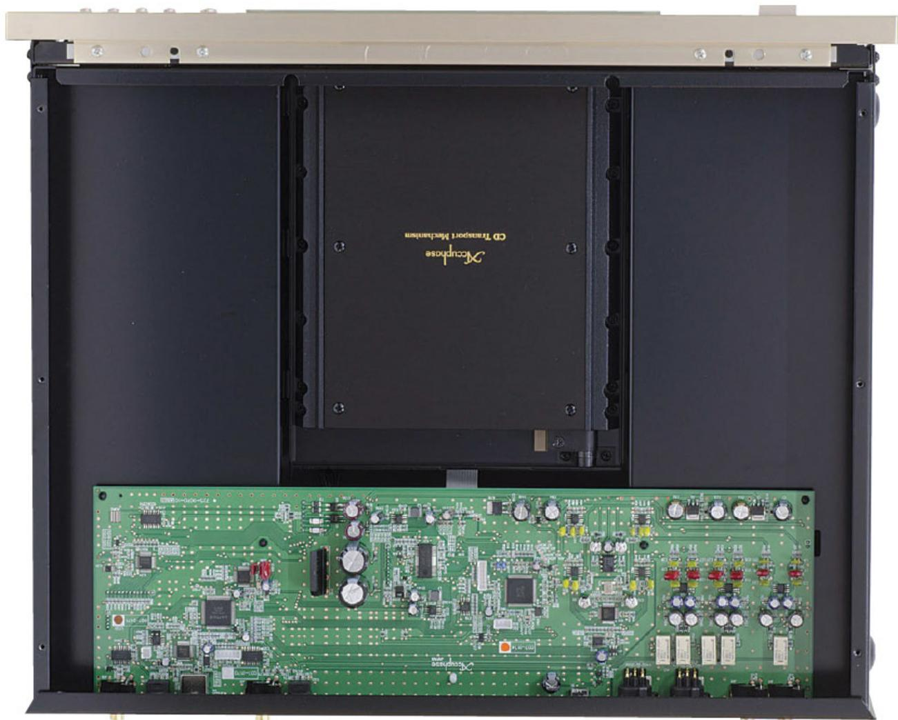
Scoperchiando l'apparecchio dall'alto, si mette in luce, al centro, una sezione meccanica blindata e collegata tramite piastrina ad un'unica scheda di circuito stampato. Questa include tutti i blocchi circuitali ben separati tra loro. Manca solo la sezione di alimentazione, accessibile dal fondo.
