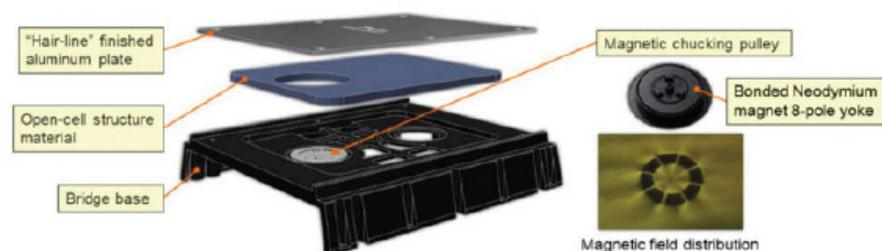
Il ponte superiore della meccanica su cui ruota la puleggia è appesantito con una ulteriore piastra di alluminio e un elemento smorzante in foam. A destra dell'immagine si vede il campo magnetico a otto poli che risulta più omogeneo e permette una rotazione che minimizza le vibrazioni.
