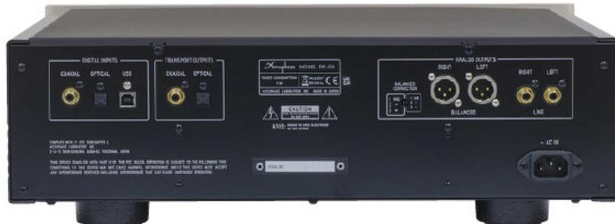
Il DP-450 è dotato di ingressi e uscite digitali, ottiche e coassiali, che ne ampliano la funzionalità fino all'utilizzo di un processore digitale. L'ingresso USB-B permette di riprodurre file ad alta risoluzione PCM e DSD con un computer. Le uscite analogiche sono sia sbilanciate che bilanciate, queste ultime con la possibilità di inversione della polarità.
