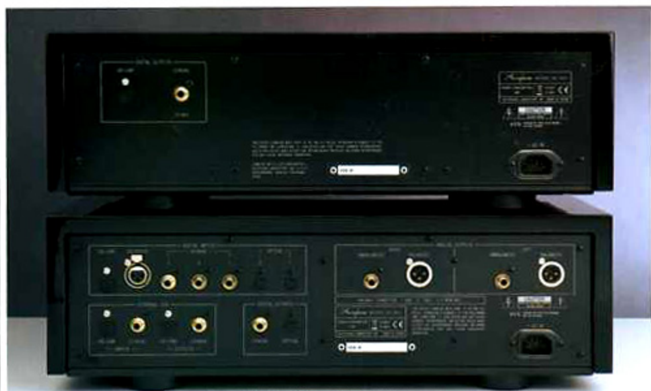
Sul pannello posteriore del DP-800 troviamo solo l'uscita ad alta velocità HS-Link e una normale uscita digitale su connettore coassiale. Sul DC-801, invece, abbiamo sulla sinistra in alto gli ingressi digitali (HS-Link, uno su connettore XLR bilanciato, tre su connettore coassiale, due su connettore ottico). Sempre sulla sinistra, ma nella parte bassa, vi sono invece le due uscite digitali (su connettore coassiale e ottico) e le connessioni per l'impiego di un processore esterno (ingresso e uscita sia su connettore coassiale sia su connettore ottico). Sulla destra troviamo invece le uscite analogiche di tipo sia bilanciato sia sbilanciato.
