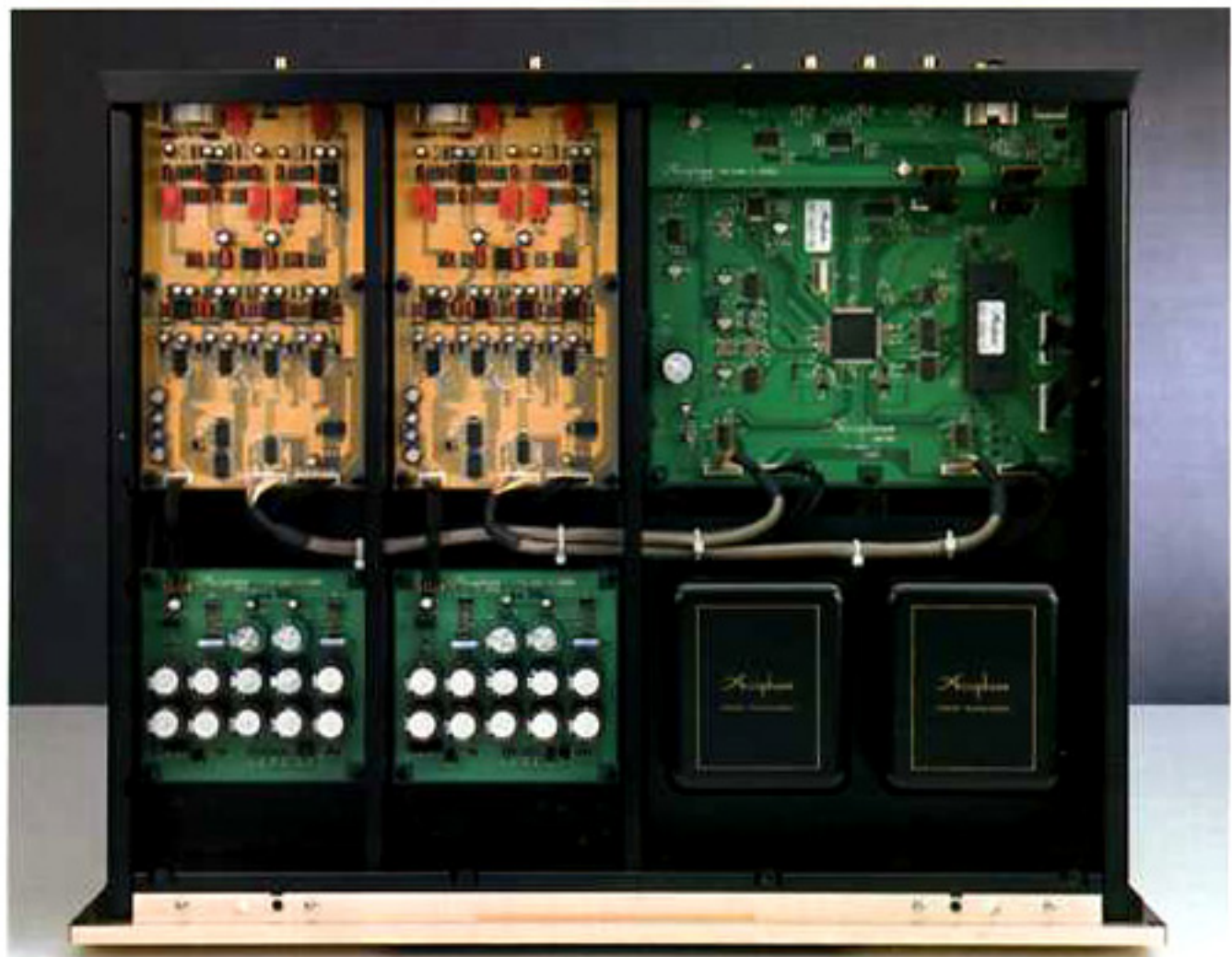
All'interno del convertitore DC-801 si distinguono le due traverse metalliche che dividono in tre parti il volume interno dell'apparecchio. Due di queste parti contengono, ciascuna relativamente ad uno dei due canali, i componenti della sezione di alimentazione (ad eccezione dei trasformatori) e quelli relativi alla conversione D/A (montati su schede in teflon). La terza parte ospita invece i due trasformatori di alimentazione e i componenti che trattano i segnali relativi agli ingressi e alle uscite digitali.
