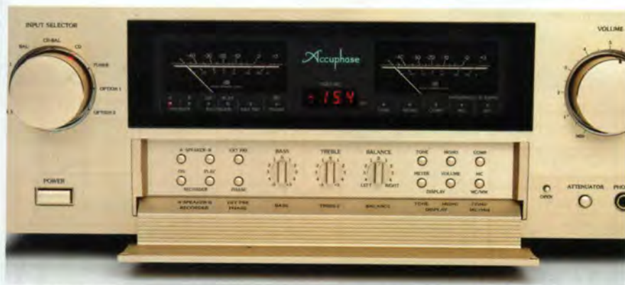
Dietro l'ampio sportellino ribaltabile sono nascosti i comandi di utilizzo meno frequente, tra cui i controlli di tono e bilanciamento e i tasti per l'eventuale disattivazione dei vu-meter e del display luminoso sul quale viene visualizzato il livello del volume.
